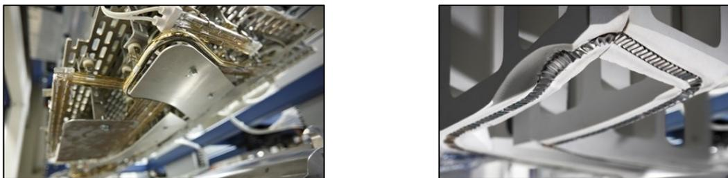
*Bild 2.5: Schweißstegkonturfolgende Infrarotstrahlersysteme aus kurzwelligen Doppelrohr-Quarzglasstrahlern (links) und mittelwelligen Metallfolienstrahlern (rechts); Quelle: FRIMO Group GmbH, Lotte*
