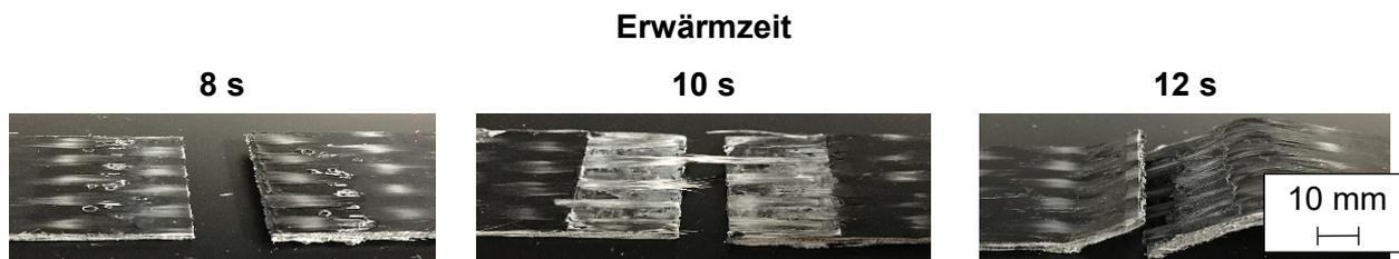
Bild 6.17: Bruchflächen von Schweißnähten aus mit elastischer Vorspannung gefügten Hohlkörpern aus PP-GF47\_2 in Abhängigkeit von der Erwärmzeit nach dem Zugscherversuch; kurzweiliger Quarzglasstrahler; Strahlerabstand = 25 mm
