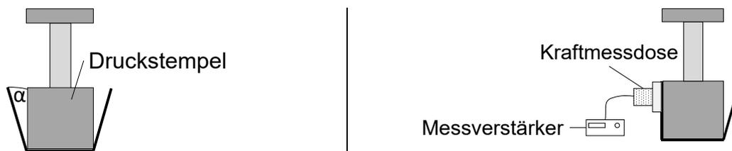
Bild 3.21: Schematische Darstellung der Messung der Rückverformungskraft am Überlappbereich von Halbschalensegmenten; links: Fixierung des Halbschalensegments mit Druckstempel; rechts: Kraftaufbringung und -messung
