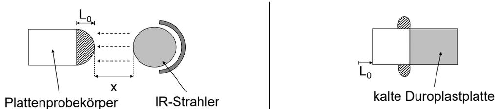
**Bild 3.10:** Schematische Darstellung des Aufschmelzversuchs (links) und Hochdruckfügeversuchs (rechts) an Plattenprobekörpern in Stumpfanordnung in der Seitenansicht;  $x$ : Strahlerabstand;  $L_0$ : Schmelzeschichtdicke
