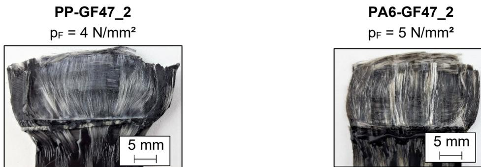
Bild 6.8: *Bruchflächen von Schweißnähten nach dem Zugscherversuch;  $p_F$ : Fügedruck; kurzwelliger Quarzglasstrahler*
